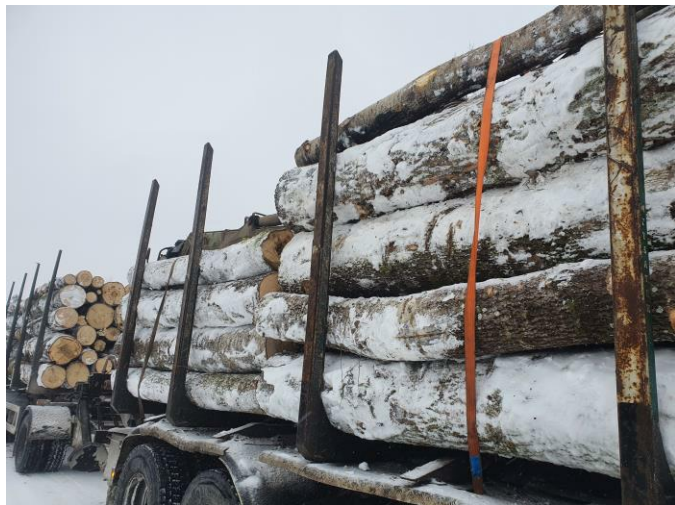
44.att. Kok vedējautomašīnas kravas nostiprināšana.
