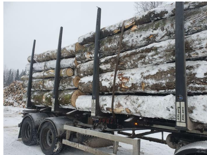
45.att. Kok vedējautomašīnas piekabes kravas nostiprināšana.
