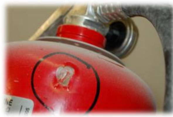
56.att. Korpusa mehāniski bojājumi
