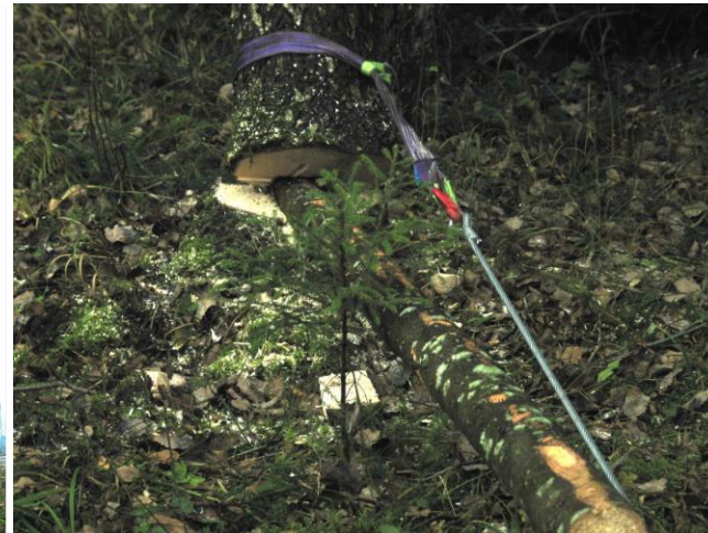
38.att. Palikņa izmantošana iekāruša koka atvieglotai novilkšanai
