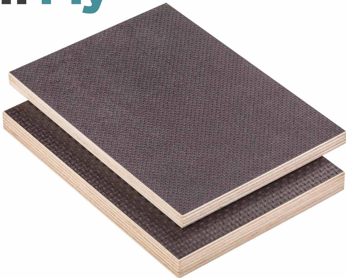
Le Metsä Wood Floor est un contreplaqué de bouleau recouvert d'un film phénolique multicouche à motif rugueux. Avec sa surface rugueuse, le Metsä Wood Floor est un matériau robuste et multifonction, destiné aux applications de pose de plancher nécessitant une surface sûre, durable et antidérapante. Le Metsä Wood Floor est disponible dans différentes tailles : standard et L.
