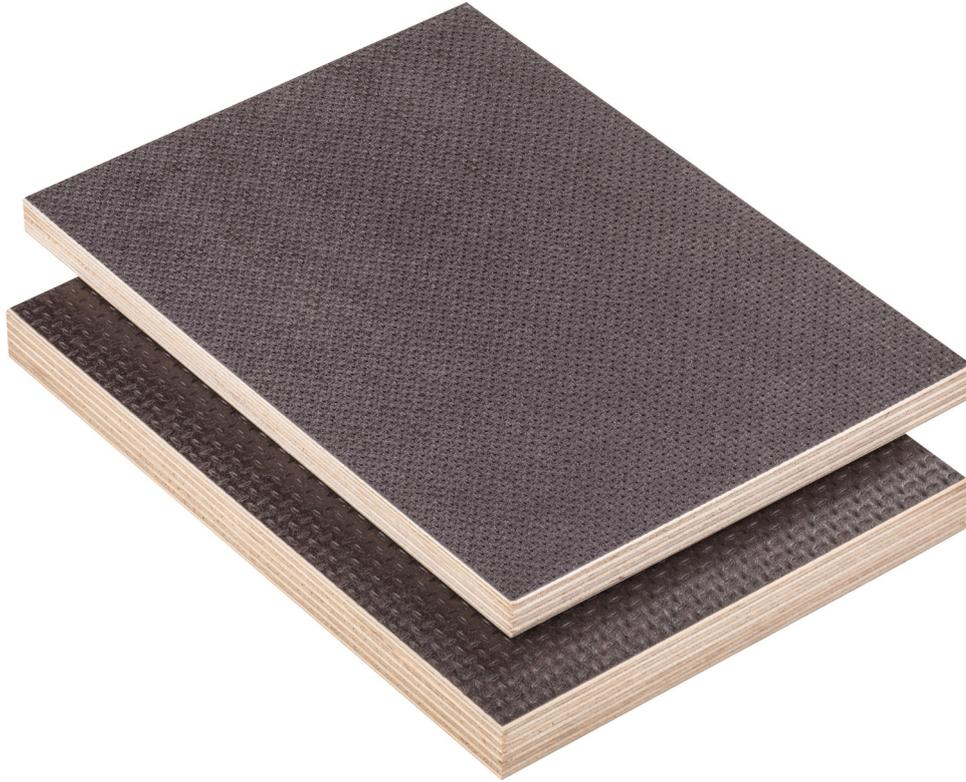
Metsä Wood Floor ist eine mit mehrschichtigem Phenolharz beschichtete Birkensperrholzplatte, die mit einer rauen Siebdruckoberfläche ausgestattet ist. Diese robuste Spezialoberfläche macht Metsä Wood Floor zur optimalen Lösung für vielfältige Anwendungsbereiche, in denen höchste Anforderungen an die Verschleißfestigkeit und den Rutschwiderstand gestellt werden. Metsä Wood Floor ist in Standard- und L-Formaten erhältlich.
