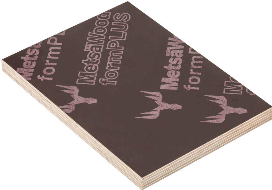
Metsä Wood FormPLUS ist die richtige Wahl für alle Betonschalungsanwendungen, bei denen hochwertige Betonoberflächen mit einer phenolharzbeschichteten Sperrholzplatte erzielt werden sollen. Die FormPLUS-Oberfläche wird einer Spezialbehandlung unterzogen, die einer Wellenbildung der Oberfläche, den sogenannten Rippings, entgegenwirkt und vom ersten Einsatz an eine glatte, hochwertige Betonoberfläche ermöglicht.
